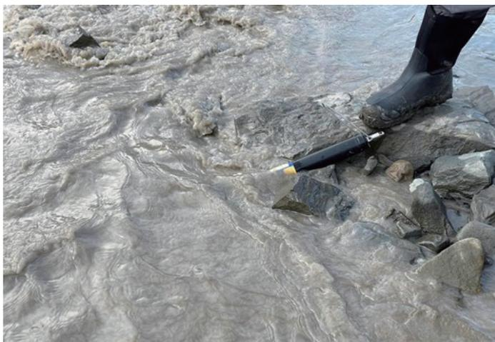
圖一、於現地放置可攜式多參數水質監測儀，用以量測水化學參數。
