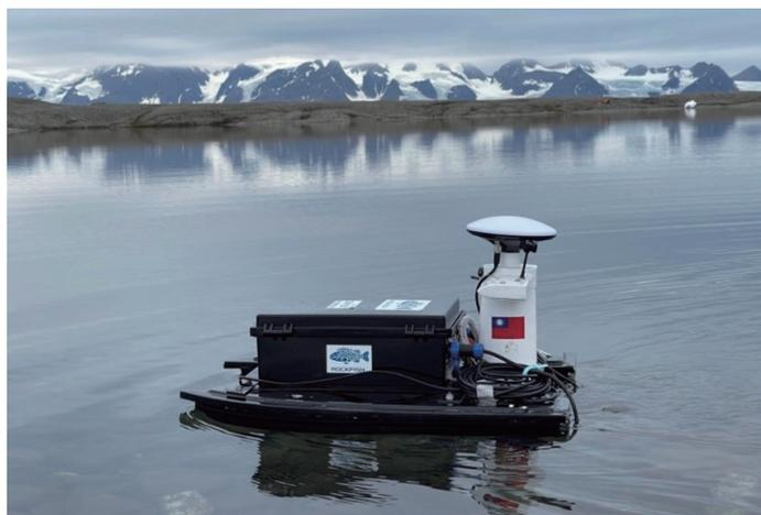
圖一、研究團隊自製的自主無人船，正在冰河湖執行測繪任務。
