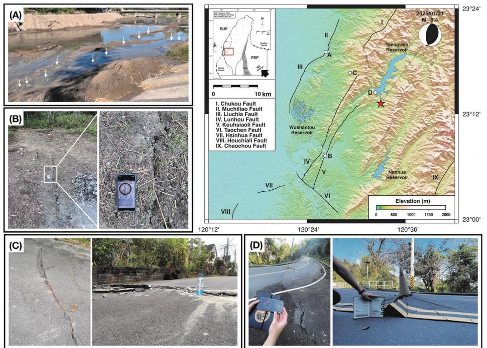
2025 年大埔地震造成噴砂(A)、地裂(B)、路面裂縫(C)、邊坡崩塌與道路損壞(D)
